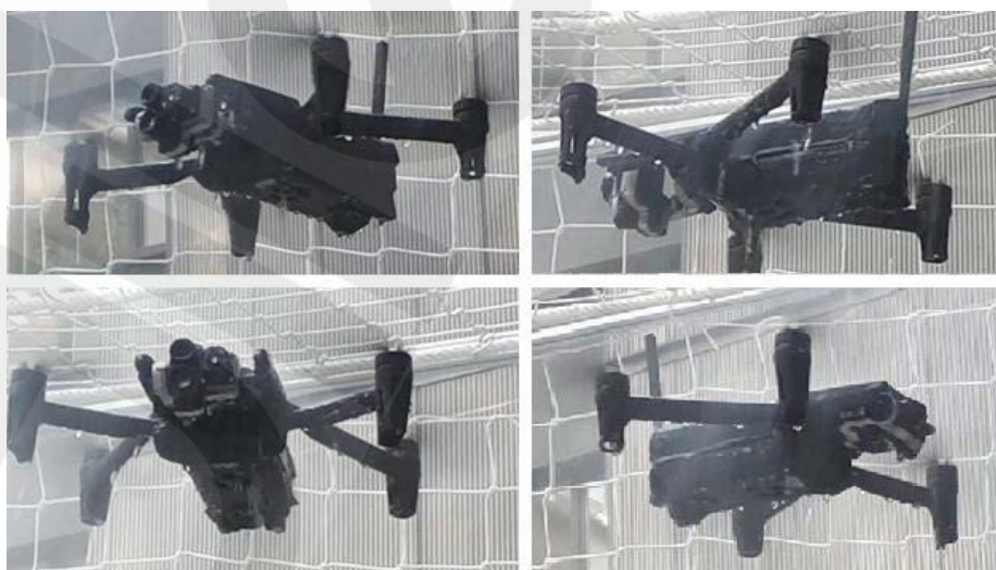
Rys. 6: Test IPX3 (opryskiwanie 10 litrami wody na minutę)
