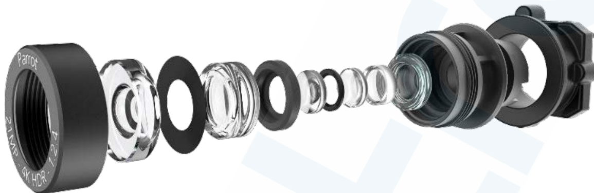
Rys. 13: Architektura jednostki optycznej drona ANAFI USA
